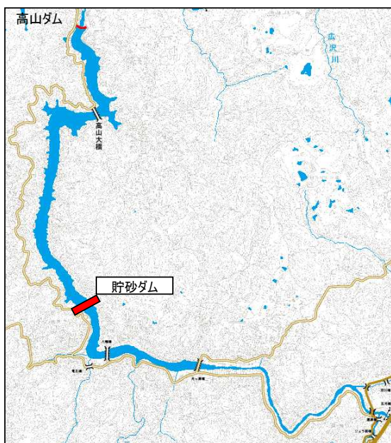
高山ダム貯砂ダム候補地
